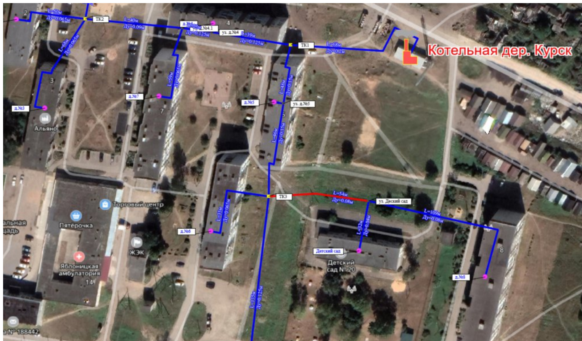
Рисунок 1.2.13 - Отказ подающего трубопровода ДУ 80 мм ТКЗ – Уз.Детский сад
